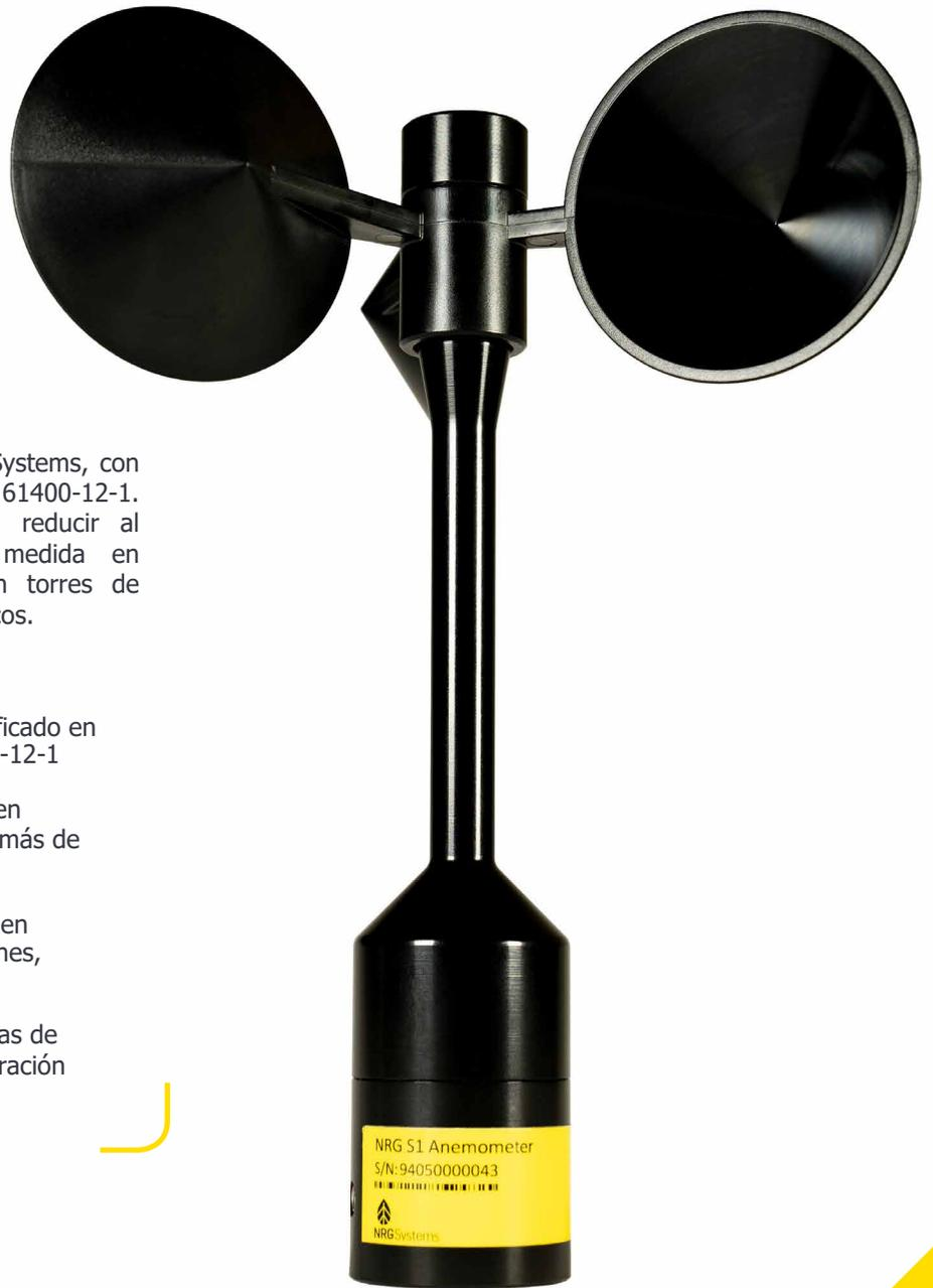
El anemómetro más avanzado de NRG Systems, con certificación de Clase 1 según IEC 61400-12-1. Máxima precisión y repetibilidad para reducir al mínimo cualquier incertidumbre de medida en campañas de prospección eólica y en torres de referencia de producción en parques eólicos.
